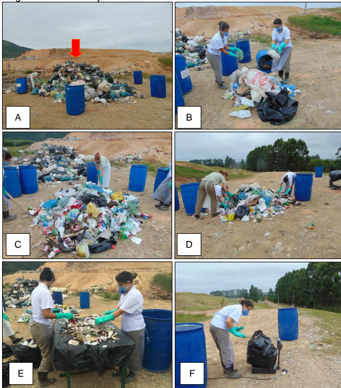
Figura 3 - A) Amostra retirada do topo da pilha; B) Rompimento das sacolas para homogeneização da amostra; C) Homogeneização da amostra através de revolvimento da pilha; D) Coleta dos dois quadrantes; E) Triagem dos resíduos; F) Pesagem dos RSU. Março de 2015.
