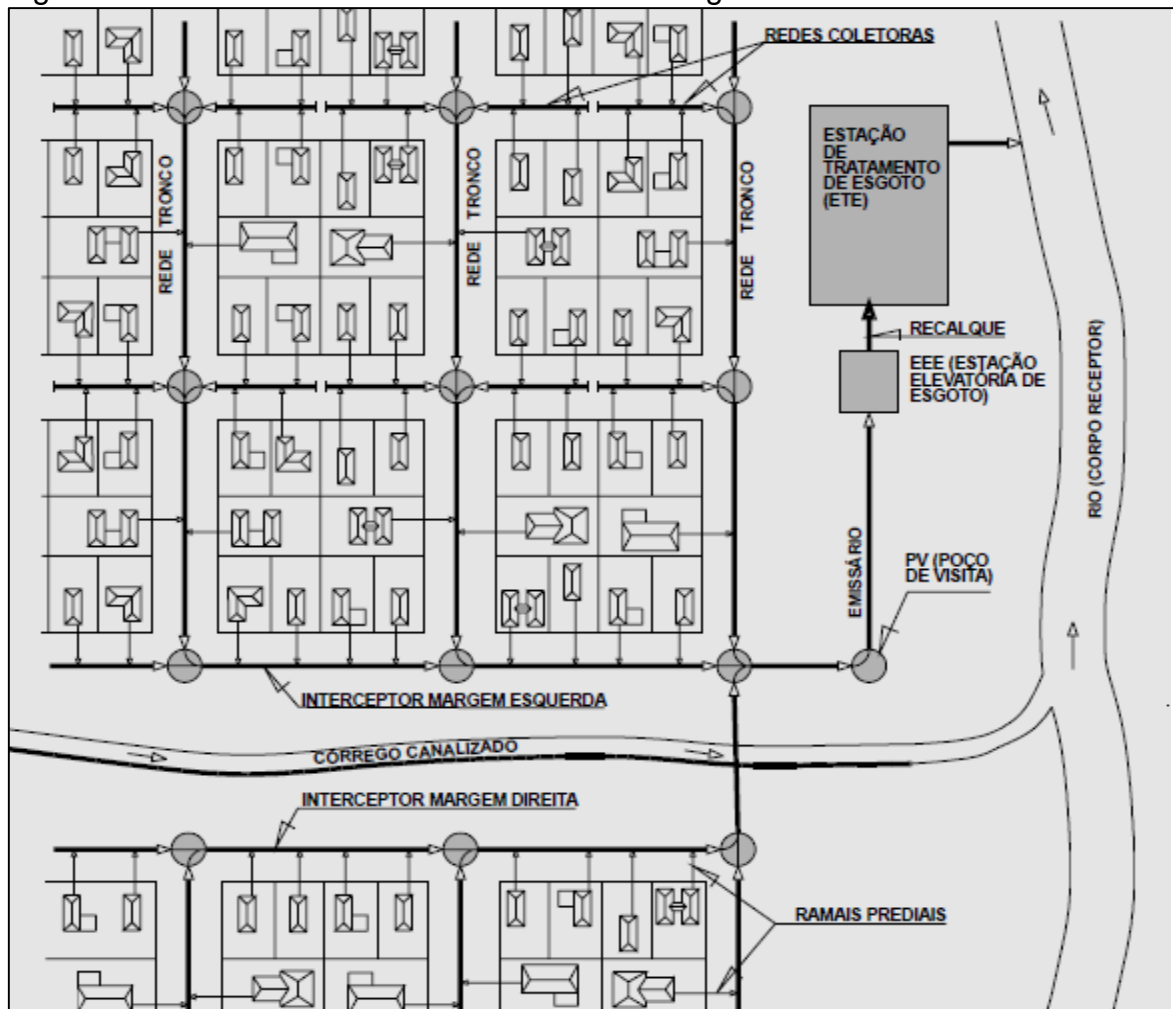
Figura 58 – Partes constitutivas do sistema de esgotamento sanitário.
